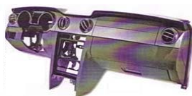
Visteon/Husky共同 開発インパネ (2colorPP同時成形、モノインジェクション)
