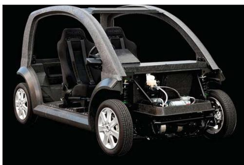
車体骨格がCFRTPのコンセプトカー
