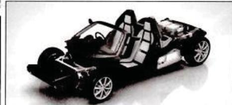
熱硬化CFRP製モノコック構造+衝撃吸収部材
