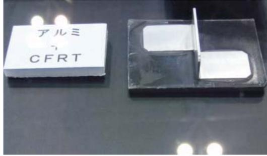
アルミとCFRTPの接合
