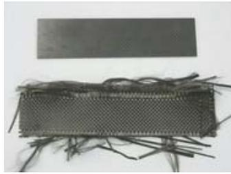
密閉容器内で高温高圧状の溶剤「亜臨界アセトン」を使い、CFRPを炭素繊維と樹脂分解物に分ける。破碎などの前処理が要らず、回収した炭素繊維も新しい樹脂を加えると、再びCFRPとして利用できる。東京の高圧容器メーカーと試作したプラントで作製したリサイクル品のせん断検査を行った結果、強度は新品とほぼ同等だった。
